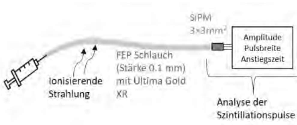
Abbildung 6-2: Funktionsschema des Fluidguide-Systems
