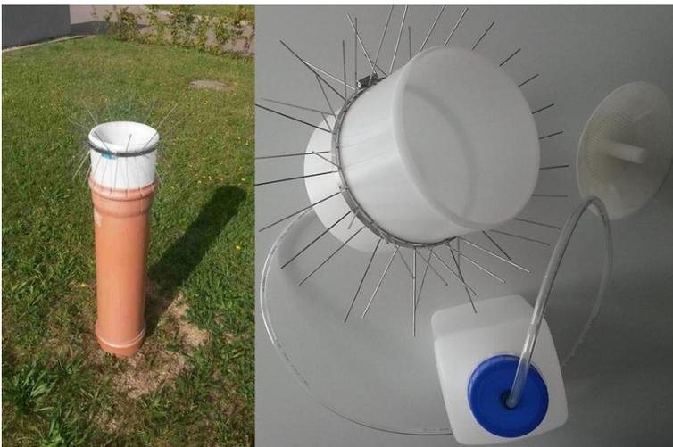
Abbildung 10-2: Niederschlags-sammler zur Tritiumbestimmung am FSR
