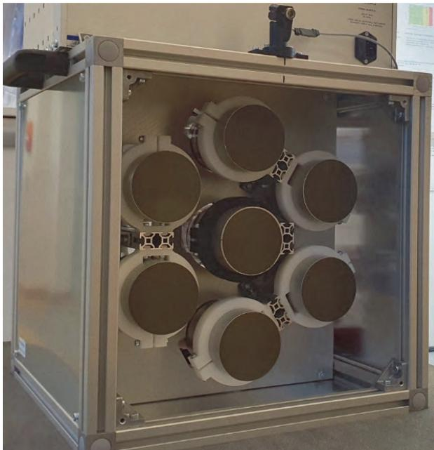
Abbildung 6-1: Anordnung aus 6 Plast- und einem CeBr<sub>3</sub>-Szintillator
