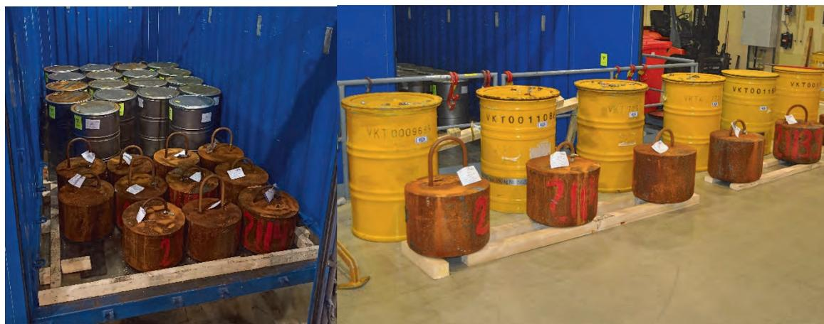
Abbildung 3-3: Entnahme von Rückläufern einer VKTA-Einschmelzkampagne von RFR-Großkomponenten mit anschließender Produktkontrolle und Verpackung in 200-l-Abfallfässer des VKTA
