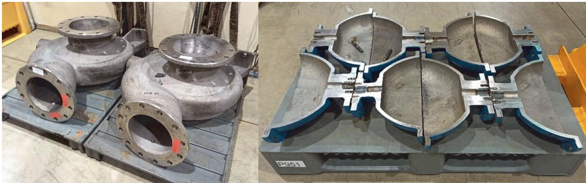
Abbildung 3-2: Zerlegung und Dekontamination von Armaturen und Pumpenteilen des Kühlkreislaufs des RFR (nach Entnahme aus einem vorher im ZLR eingelagerten Konrad-Container (KC))
