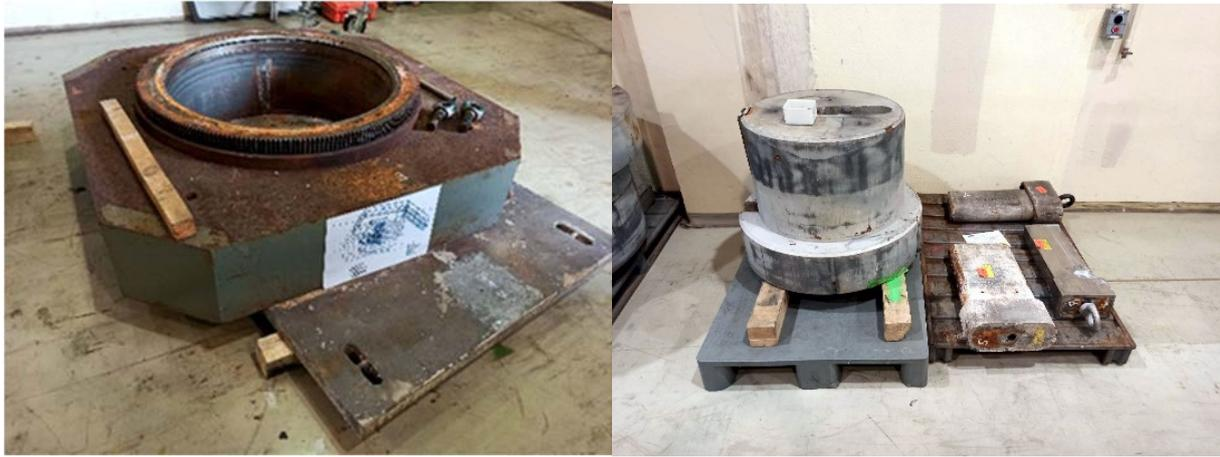
Abbildung 3-1: Demontage und Zerlegung von Komponenten des Ringzonenreaktors für freigabevorbereitende Probenahmen und Messungen
