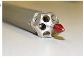
RFR wird mit WWR-M-Brennelementen (U-235 Anreicherung: 36%) betrieben
