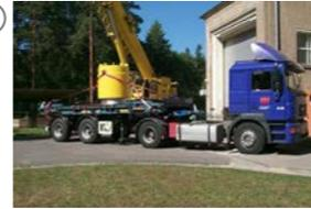
951 Brennelemente werden in 18 CASTOR®-MTR2-Behälter umgeladen und in die Transportbereitstellungshalle überführt
