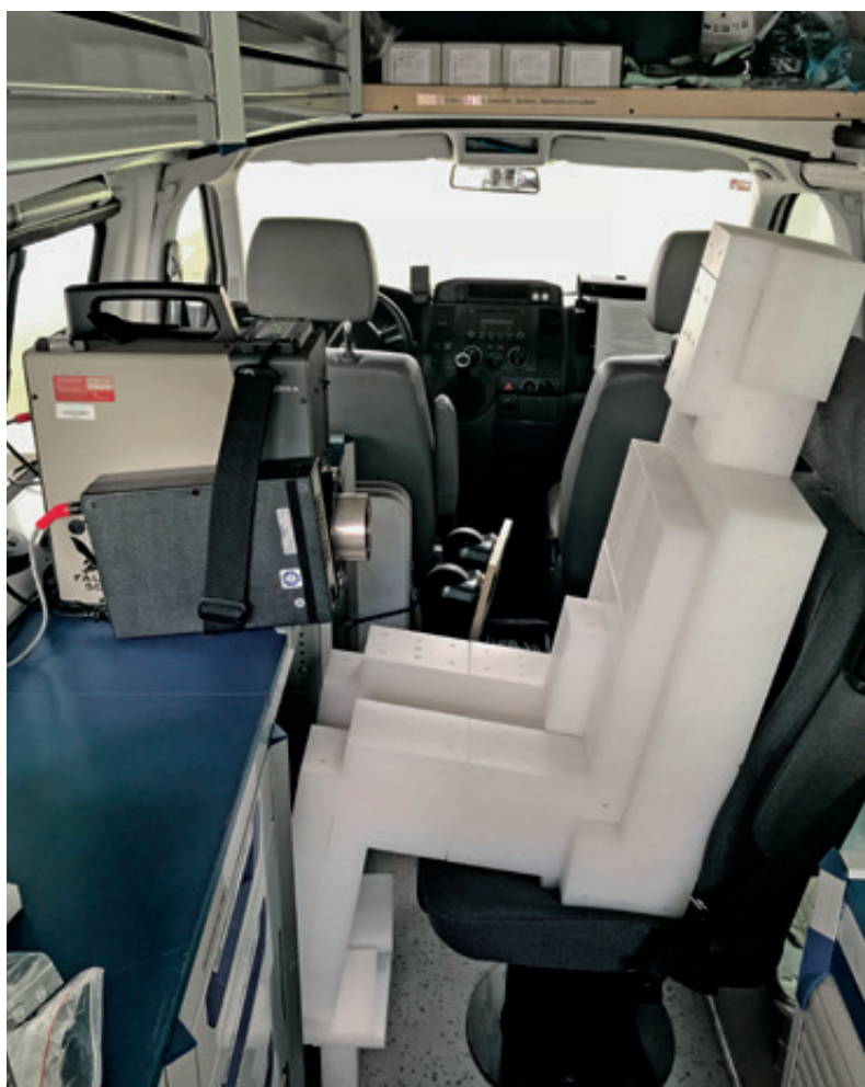
Abb. 3: Kalibrieranordnung sitzendes F4-Phantom im Messfahrzeug (Bachelorarbeit 2018)
