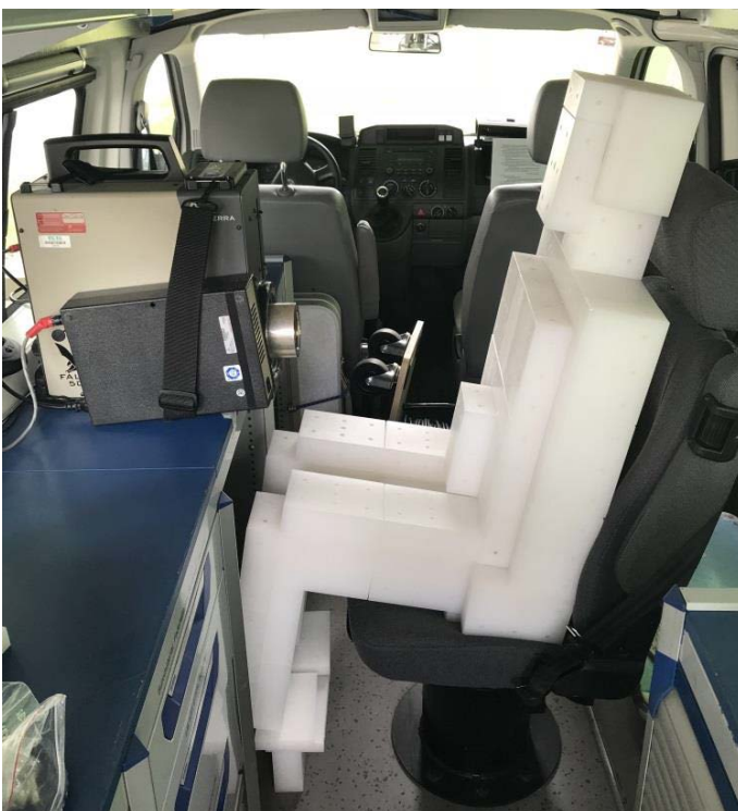
Abbildung 9-1: Detektor (links) und Phantom (sitzend) im Messfahrzeug
