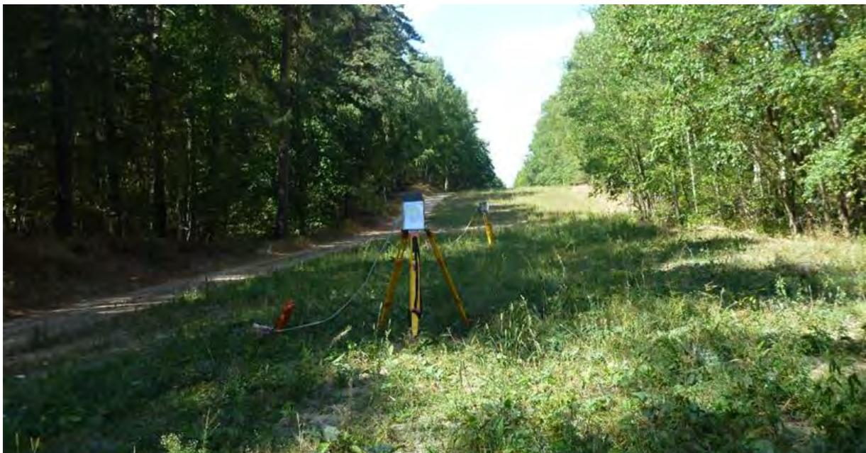
Abbildung 4-2: In-situ-Gammaskontrometrie auf den Haldenaufstandsflächen des Postenweges
