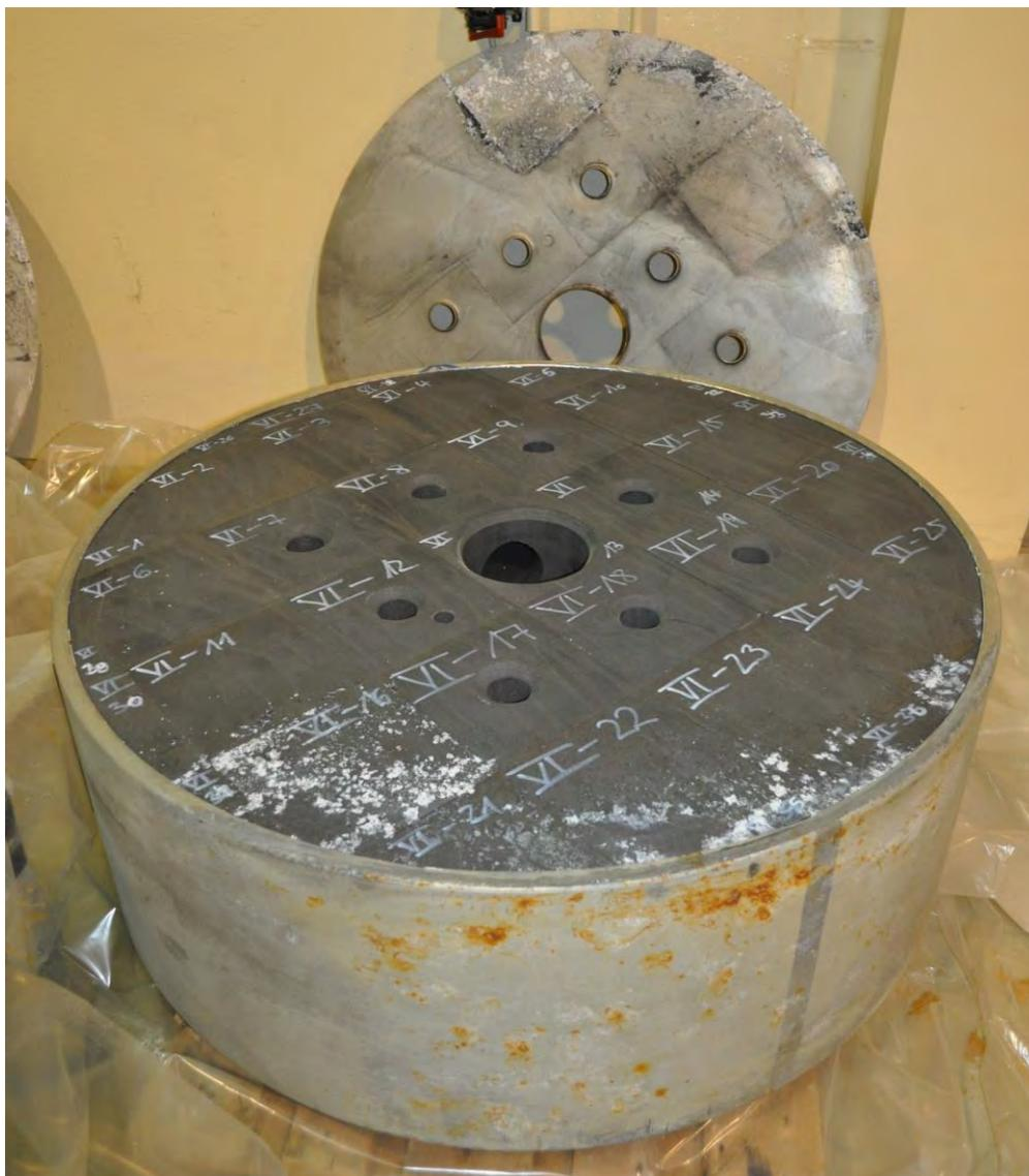
Abbildung 3-5: Für die Probenahmen geöffnetes Graphitsegment der Thermischen Säule des RFR
