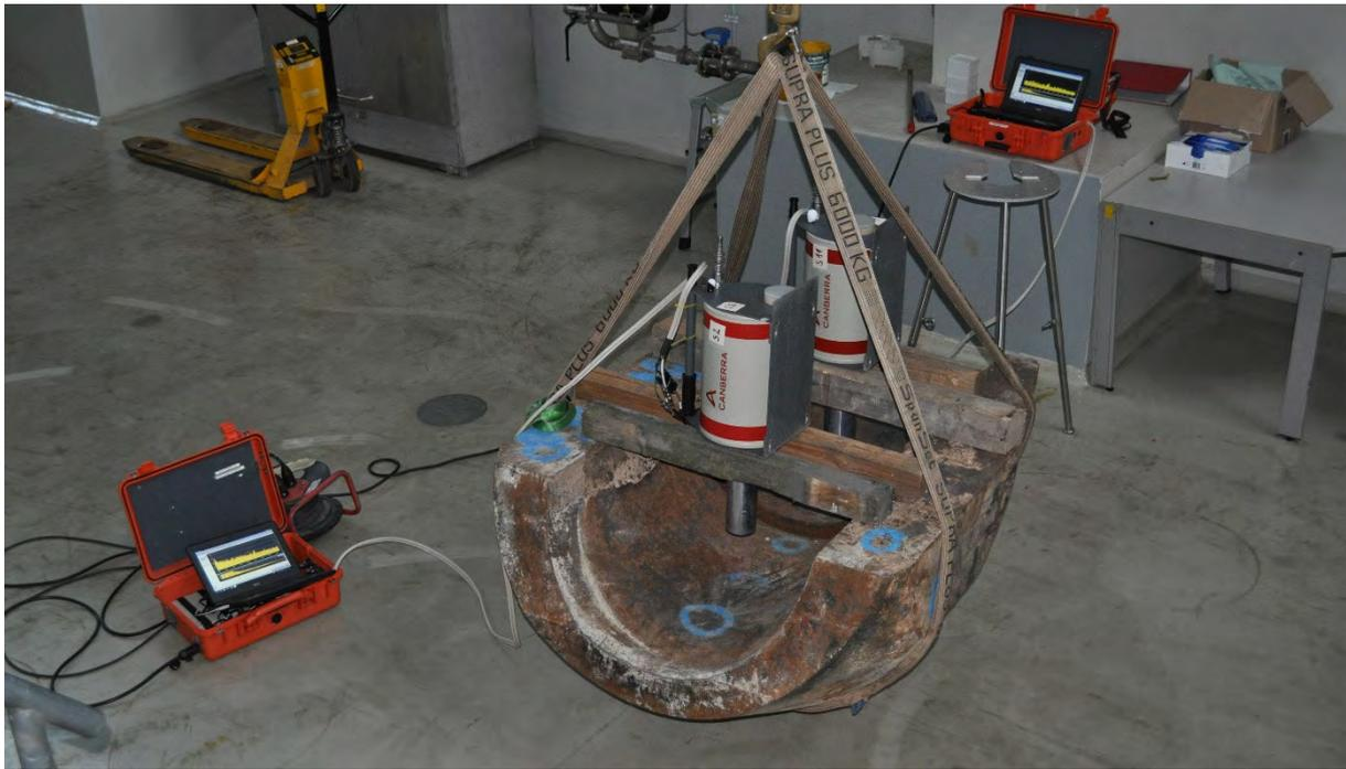
Abbildung 3-5: In-situ-Gammaspektrometriemessung (ISG) an einem Segment der RFR-Brennelementrutsche
