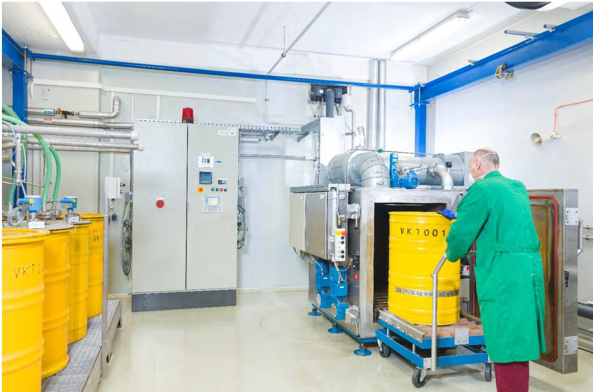
Abbildung 4-8: Beschickung der 2-Fass-Trocknungsanlage der ESR mit 200 l-Abfallfässern
