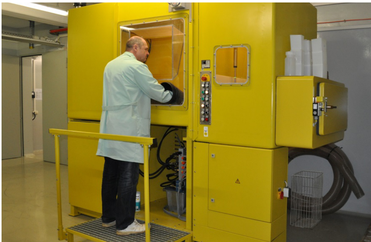
Abb. 4-7 Arbeiten zur Materialtrennung im Rahmen der GSI-Entsorgungskampagne in der Sortierbox der ESR
