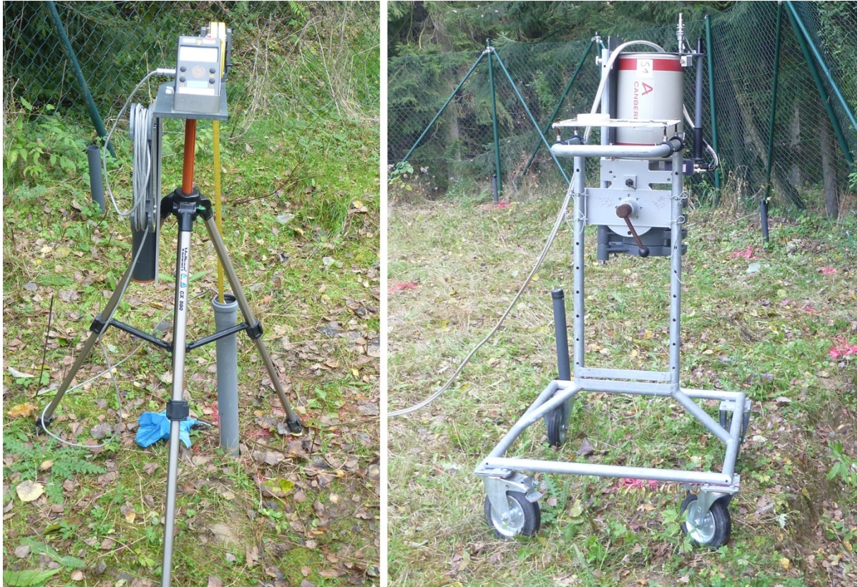
Abb. 4-17 Bohrlochmessungen und kollimierte ISG im Teilbereich 13
