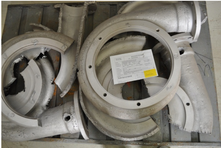
Abb. 4.2.6-1: dekontaminierte Pump- penteile des RFR
