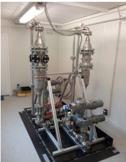
Abbildung 4.4.4-1: Mobiler Korrosionsmessstand (linkes Foto) und Containerstellplatz (rechtes Foto) für die tiefe Geothermie in Neustadt-Glewe
