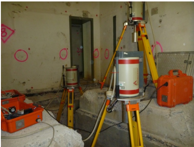
Abbildung 4.4.2-1: Messungen mittels In-situ- Gammaspektrometrie im Raum 27-2 (ehem. Filterraum 1. Kühlkreislauf)
