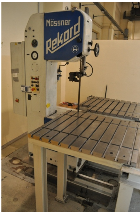
Abb. 4.2.6-2: Bandsäge SSF 520 mit umgebautem Arbeitstisch in der ESR
