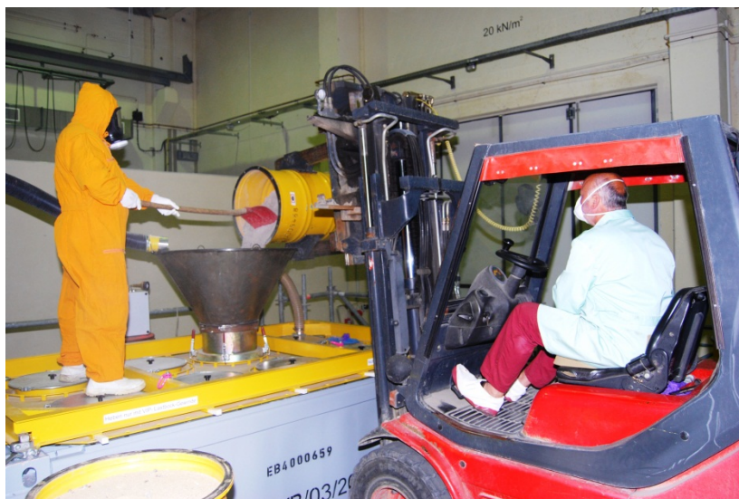
Abbildung 4.2.6-1: Umschütten von nicht brennbaren Abfällen in Konrad IV-Container
