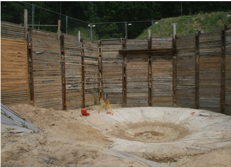
Abbildung 4.4.2-2: Freimessung der Bodenplatte des Gebäudes 30.3 mittels In-situ-Gammaspektrometrie
