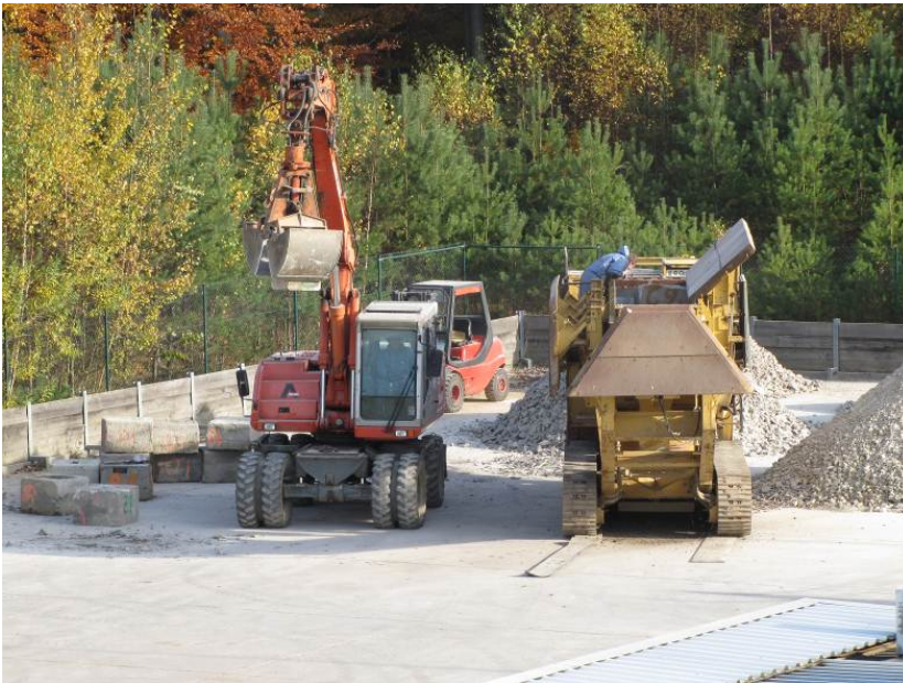
Abbildung 4.2.6.3-1: Brechen von Betonsteinen auf dem Pufferlager
