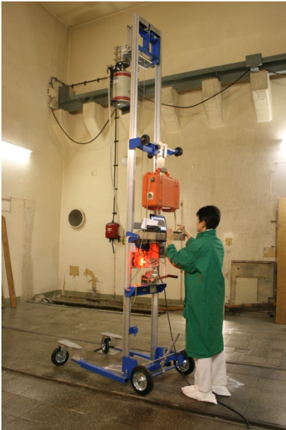
Abbildung 4.4.3-1: Messungen mittels In-situ-Gammaspektrometrie im Raum der ehemaligen Anlage Zyklotron U-120
