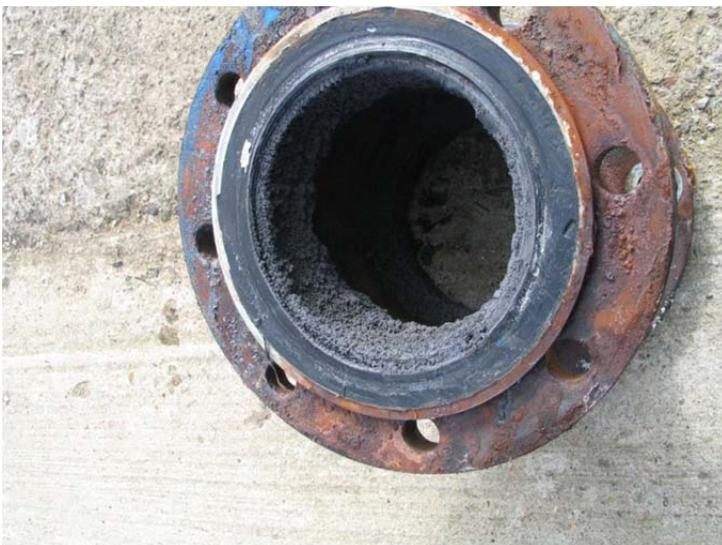
Abb. 8-1: Typische radioaktive Ablagerungen in einem Flansch der Förderbohrung der Anlage Neustadt-Glewe
