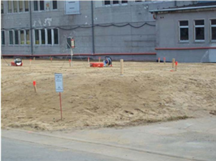
Abb. 4-8: In-situ-Beweissicherungsmessungen im Abbruchbereich II nach Aufbringen der Abdeckschicht
