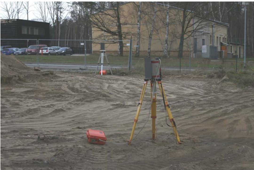
Abb. 3.4.2-3: Entscheidungsmessungen im Betriebshof zum Gebäude 91 mittels In-situ-Gammaspektrometrie
