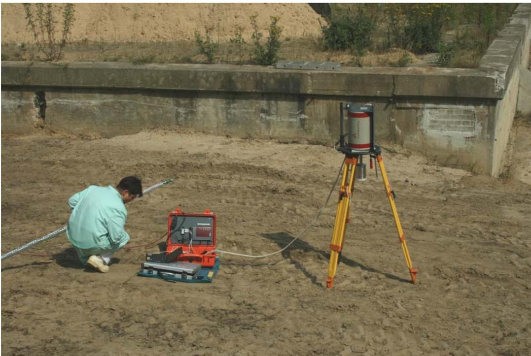
Abb. 3.4.2-5: Entscheidungsmessungen im Umfeld des Gebäudes 99 mittels In-situ-Gammaspektrometrie entsprechend dem Bodensanierungskonzept
