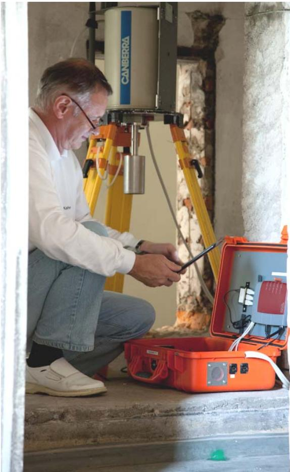
Abb. 3.4.2-2: Freigabevorbereitende Messungen im Obergeschoss des Gebäudes 91 mittels In-situ-Gammaspektrometrie
