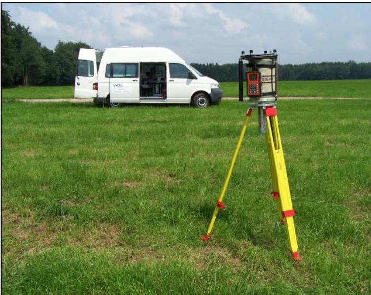
Abbildung 3.3.3-6: Neues Messfahrzeug mit In-situ- $\gamma$ -Spektrometer am Messpunkt Wilschdorf
