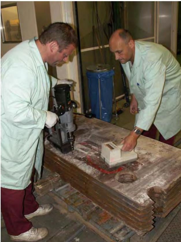
Abb. 3.2.6.1.2-3: Kontaminationskontrolle an Abschirmsegmenten
