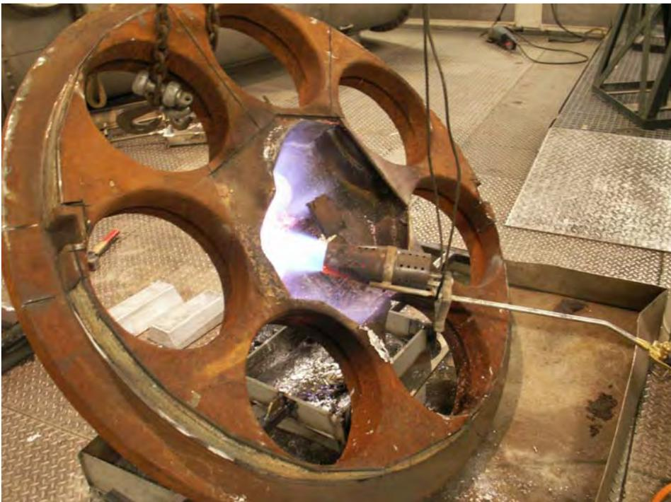
Abb. 3.2.6.1.2-5: Ausschmelzen von Blei aus einer Abschirmung
