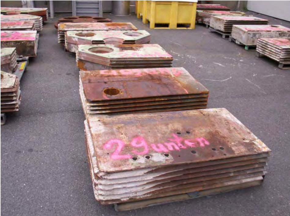
Abb. 3.2.6.1.2-4 Dekontaminierte Abschirmsegmente
