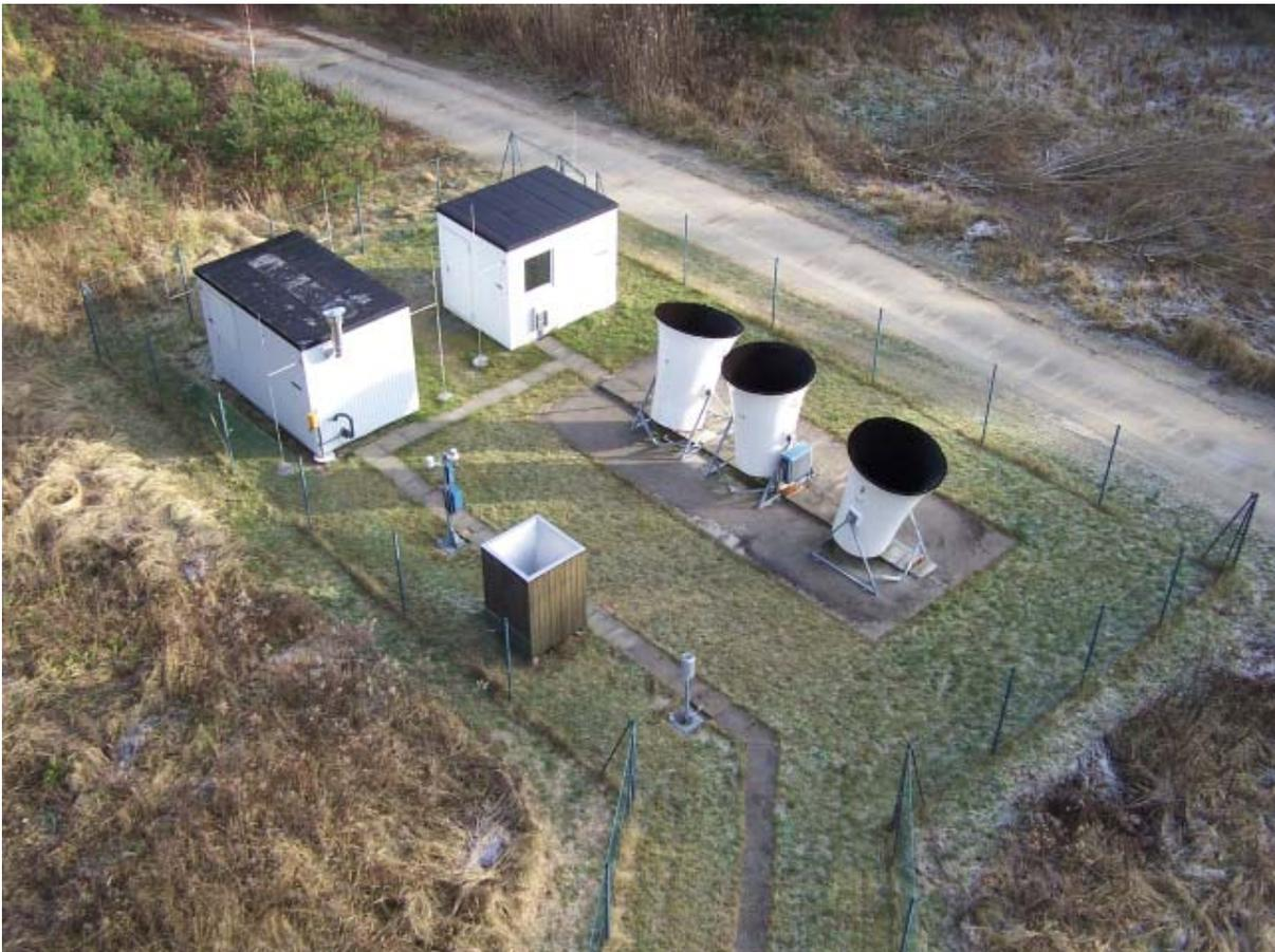
Abbildung 3.3.3-4: Neue Immissionsmessstation (links) und Niederschlagssammler am Standort des Meteorologischen Messfeldes
