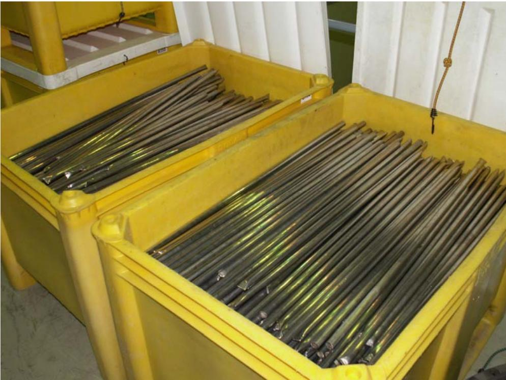
Abb. 3.2.6.1.2-3: Dekontaminierte Wärmeübertragerrohre, für die Freimessung vorbereitet
