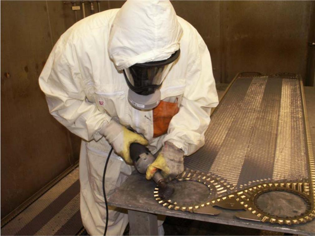
Abb. 3.2.6.1.4-1: Dekontamination von Titan-Wärmeübertragerplatten
