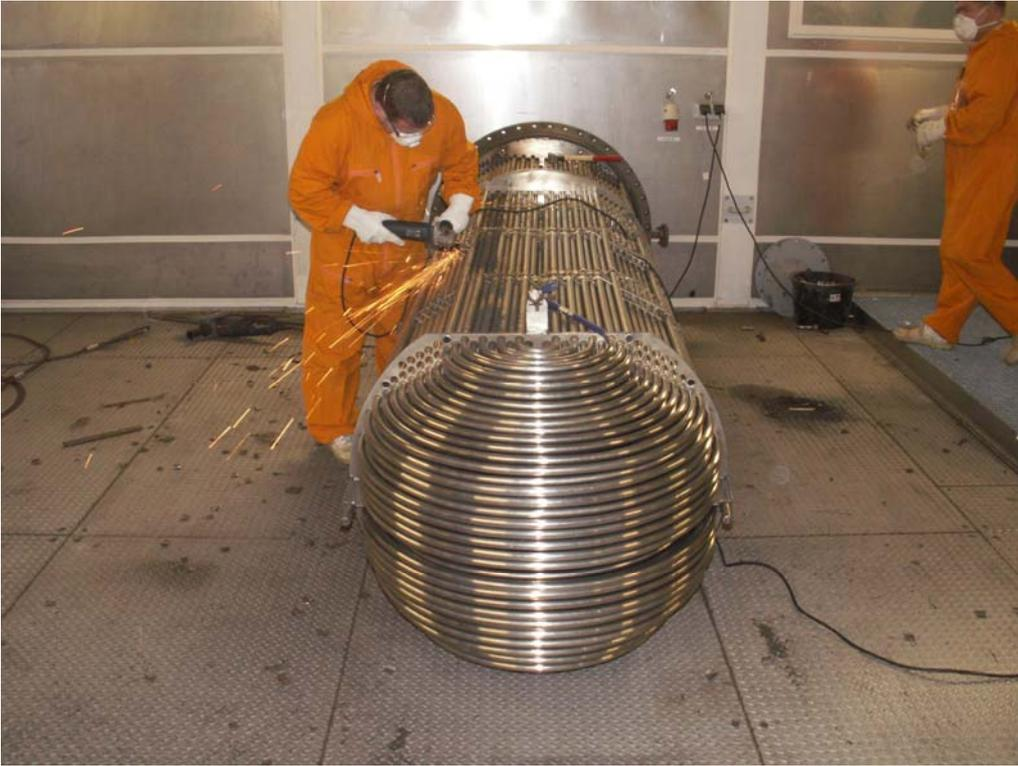
Abb. 3.2.6.1.2-2: Heraustrennen der Wärmeübertragerrohre
