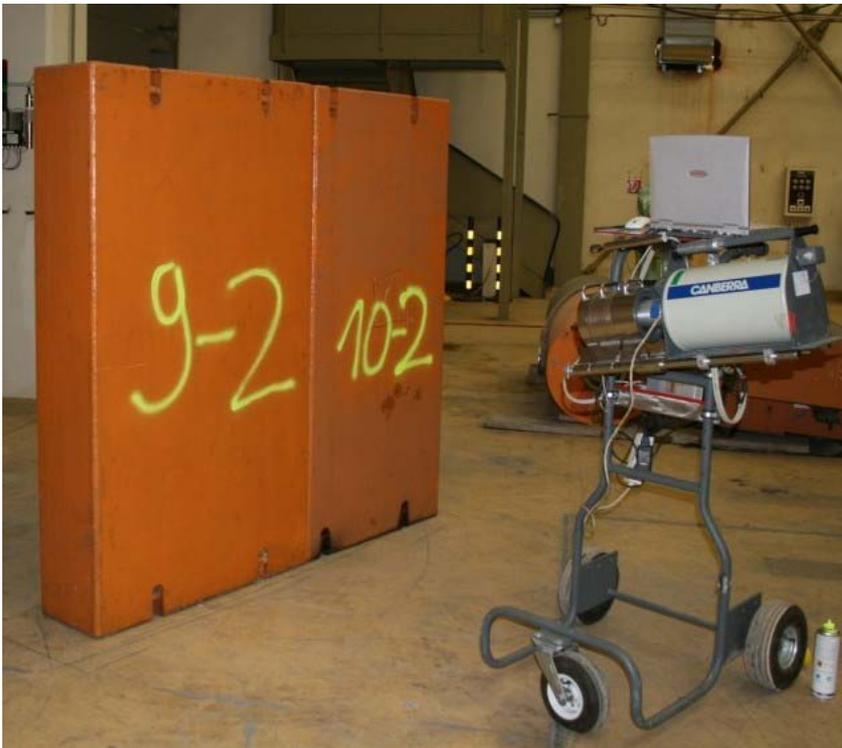
Abb. 3.4.2-1: Radiologische Bewertung von Abschirmwänden mittels In-situ-Gamma-spektrometrie in der Halle des RFR (Rückbaukomplex 1)
