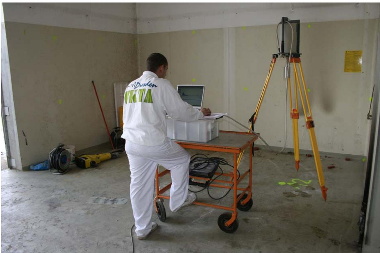
Abb. 3.4.2-3: Entscheidungsmessungen mittels unkollimierter In-situ-Gammaspektrometrie im Gebäude 91.1 (Rückbaukomplex 3)
