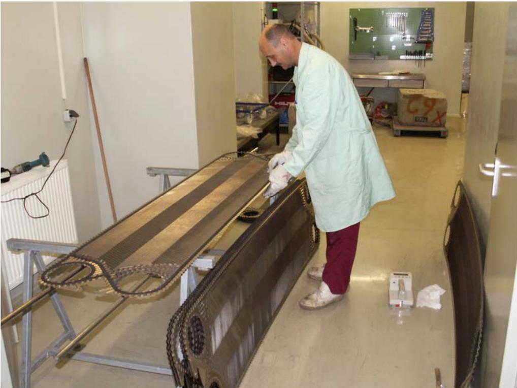
Abb. 3.2.6.1.4-2: Kontaminationskontrollen an dekontaminierten Titan-Wärmeübertragerplatten
