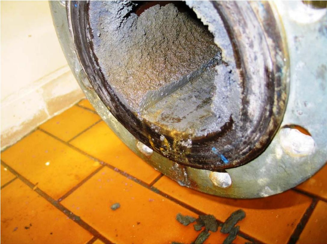
Abb. 3.4.4-2: Ablagerungen von Pb-Verbindungen im Inneren eines Rohres aus der Geothermieanlage
