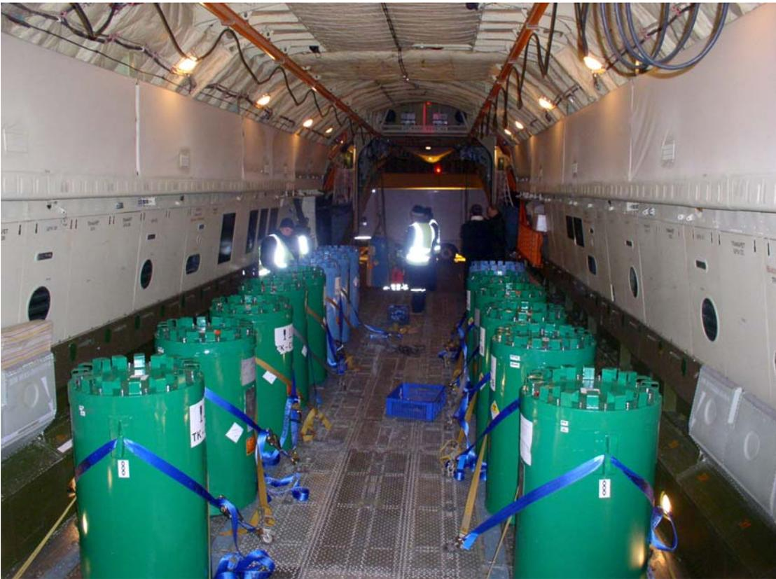
Abb. 3.2.2.2-3: Blick in den Laderaum des mit TK-S16-Transportbehältern beladenen russischen Transportflugzeugs vom Typ IL 76
