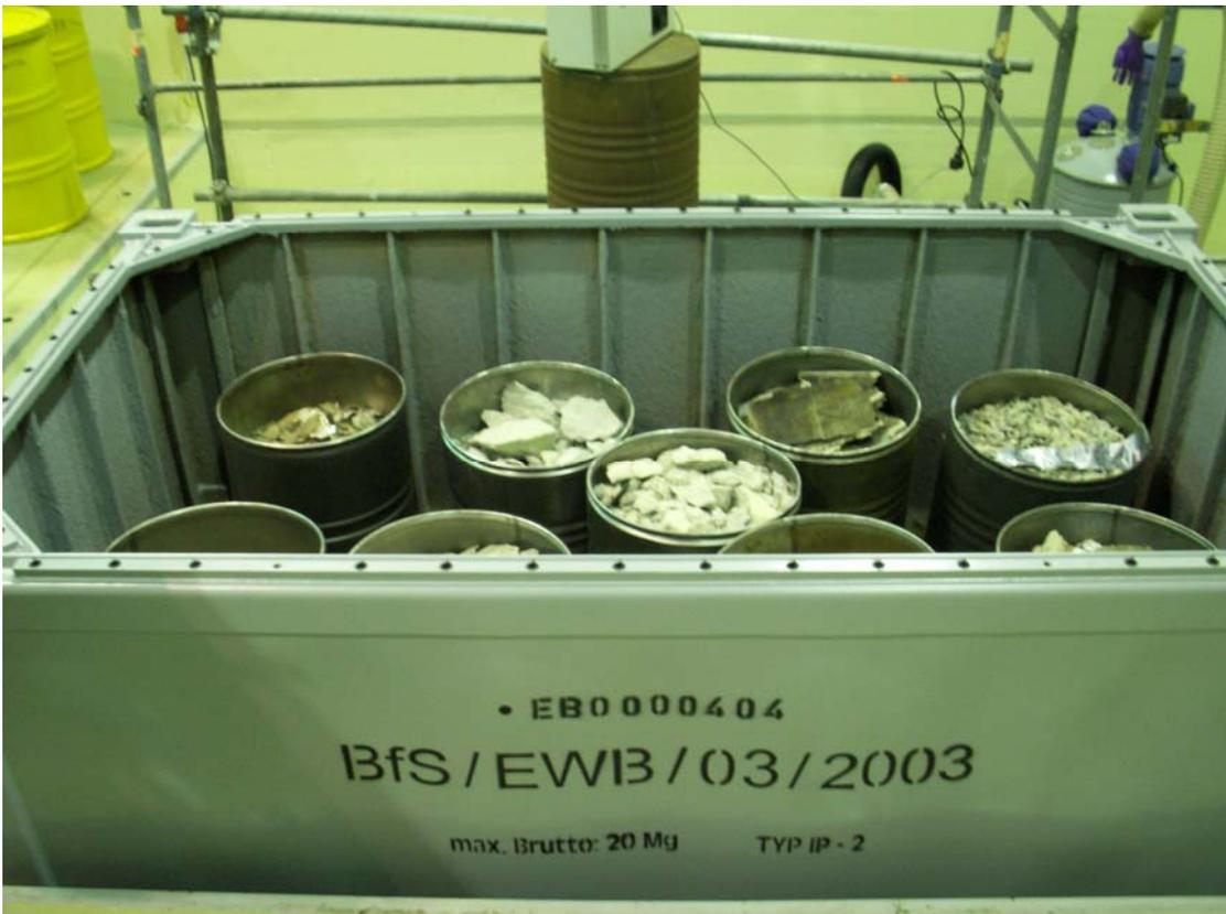
Abb.: 3.2.5.1.3-1: 20 Fuß-Großcontainer (GC) mit eingestellten Presstrommeln
