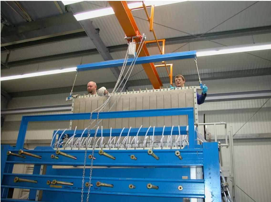
Abb. 3.4.3-8: Endmontage der Elektrolysezellen
