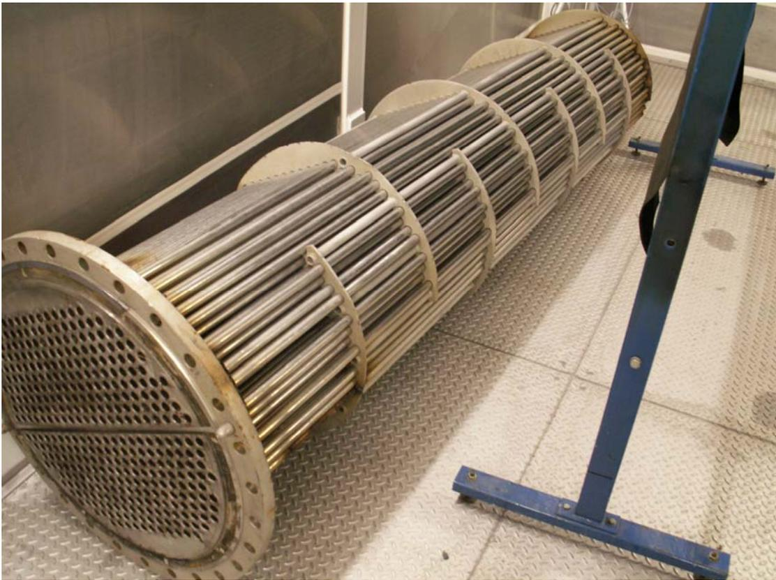
Abb.: 3.2.5.1.2-3: Rohrbündel des Wärmeübertragers 5 des RFR
