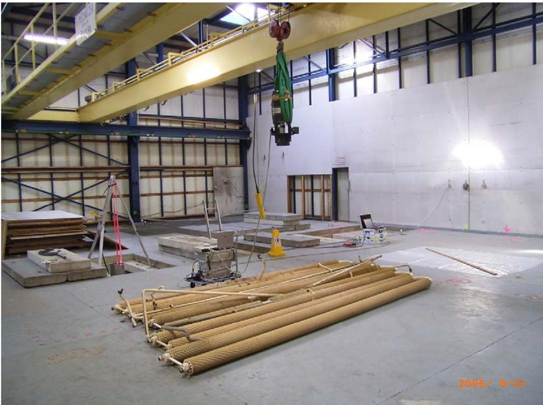
Abb. 3.4.3-4: HMI, Berlin: Innenansicht, im Vordergrund: Freimessung von Heizungselementen mittels kollimierter In-situ-Gammaspektrometrie (Messsystem am Kran)
