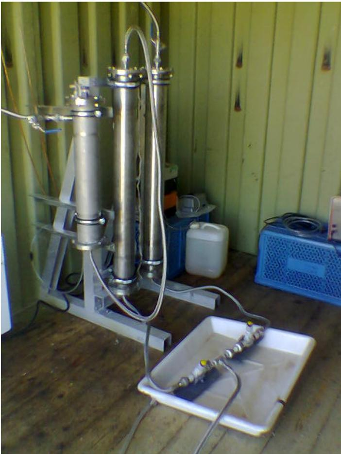
Abb. 3.4.3-10: Versuchsaufbau Uranabtrennung
