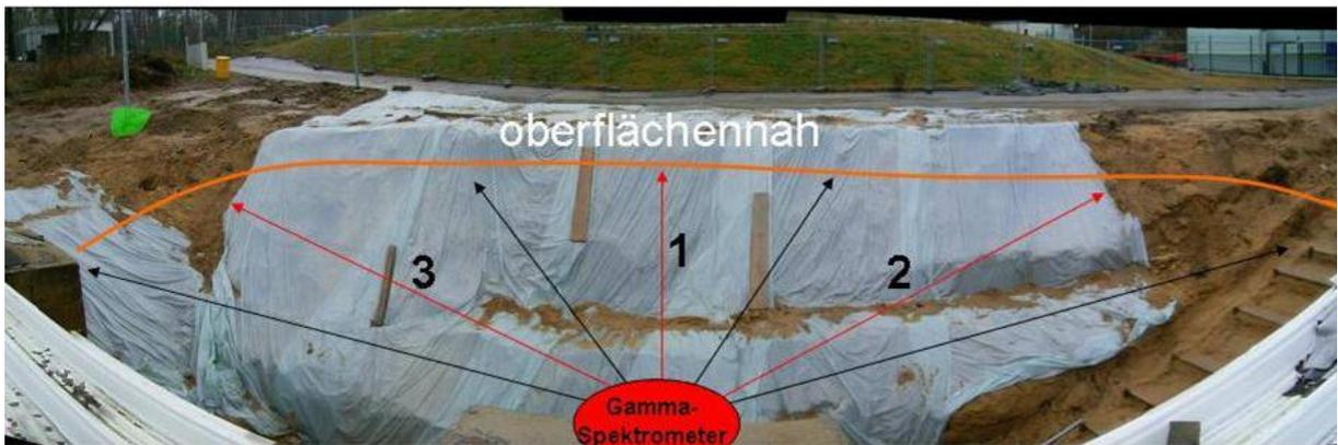
Abb. 3.4.2-2: In-situ-Gammascanning der Böschung im Baufeld der NW-Seite des Geb. 99 (Rückbaukomplex 3)
