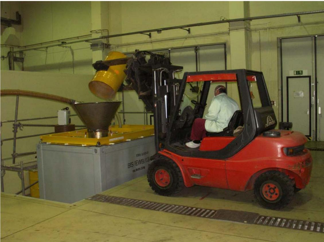
Abb.: 3.2.5.1.3-2: Verfüllen eines GC mit Schüttgut aus 200-Liter-Abfallfässer
