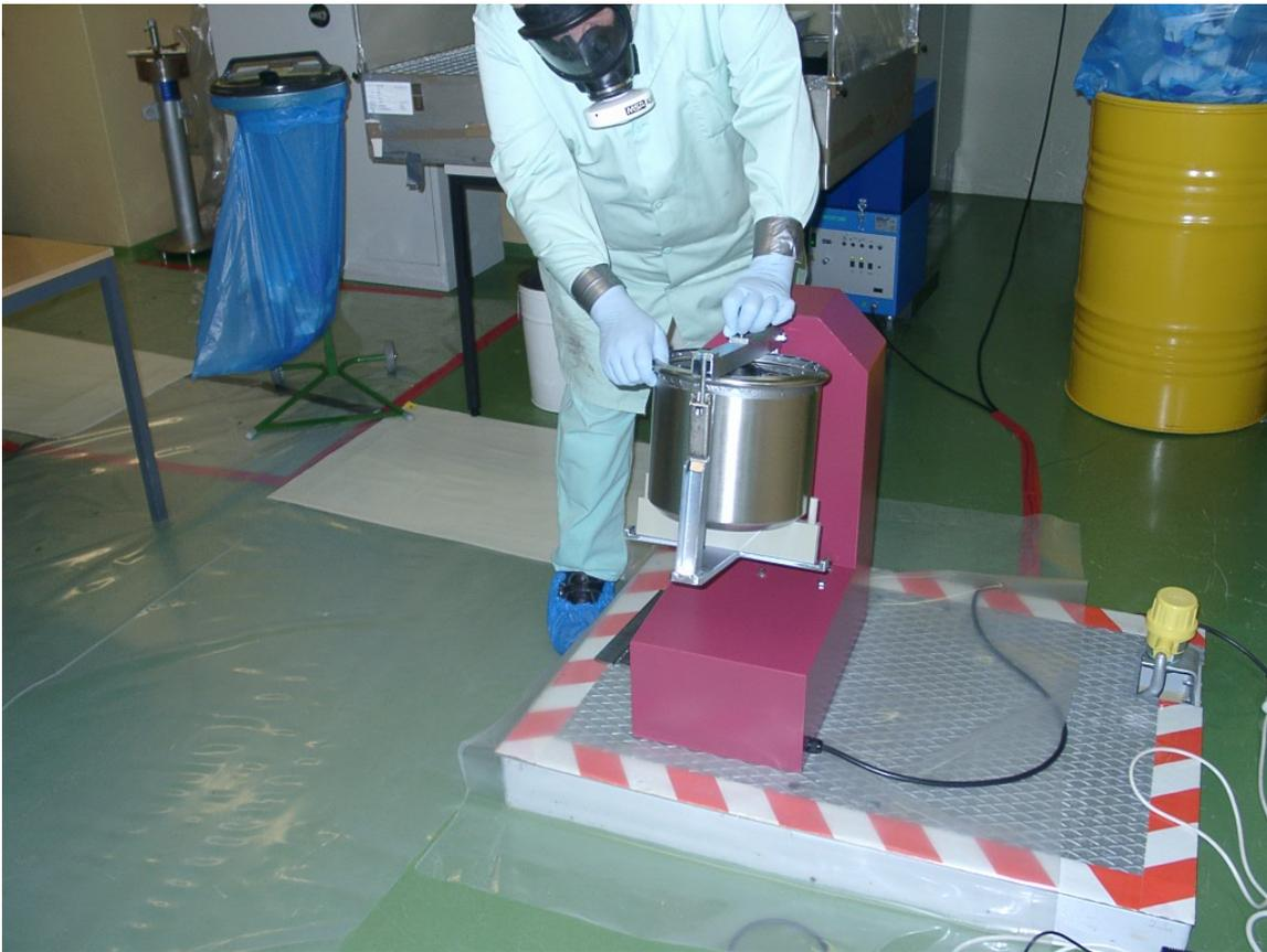
Abb. 3.2.2.2-1: Uranoxid-Pulverblendung mit einem Mixomat-Trommelmischer
