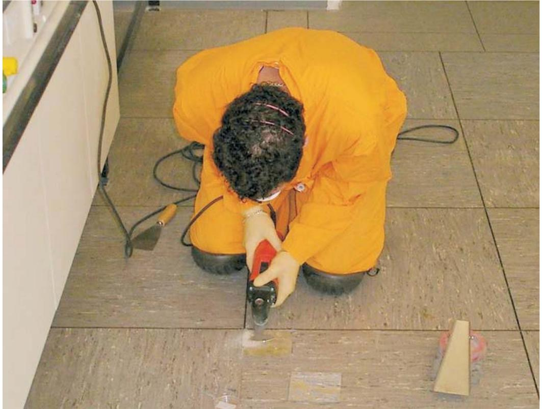
Abbildung 3.5.3-3: Kratzprobenentnahme auf dem Fußboden
