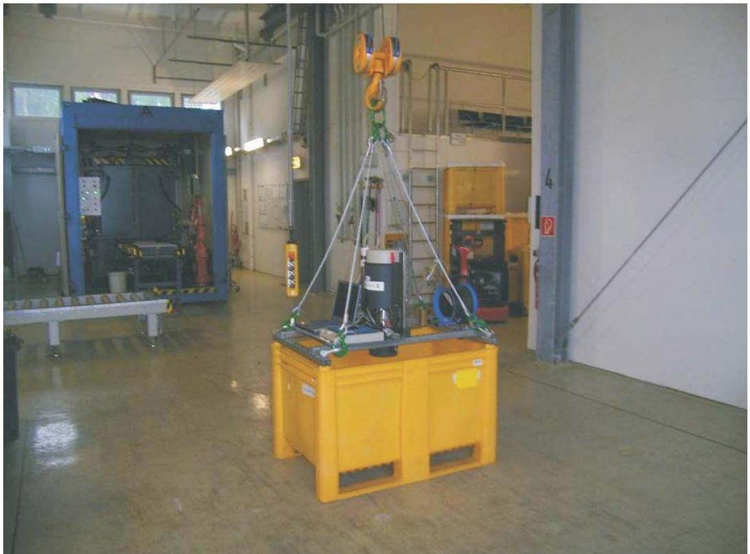
Abbildung 3.5.3-5: In-situ-Gammaspektrometrie an einer PE-Box mit Sinterofensteinen
