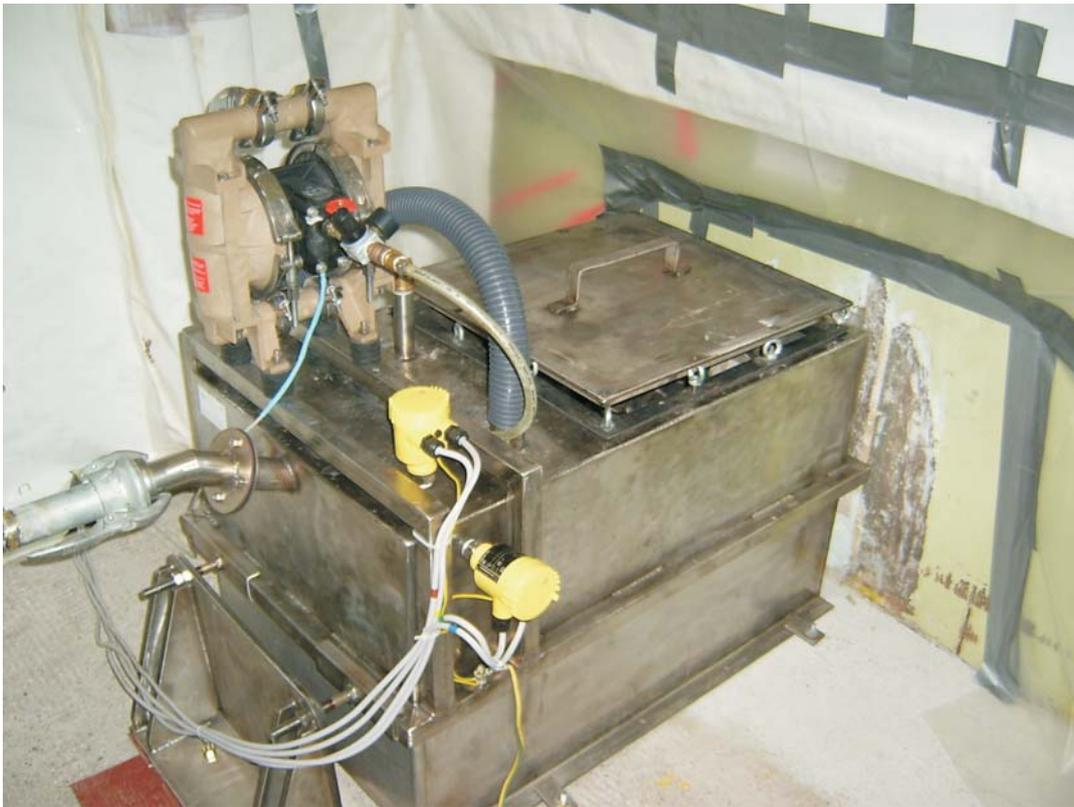
Abbildung 3.2.3.1-2: An der Rückwand der Heißen Zelle angedockte Spezialschleuse des Wasser-Hochdruck-Reinigungssystems zum Reinigen des Zellenabflusses
