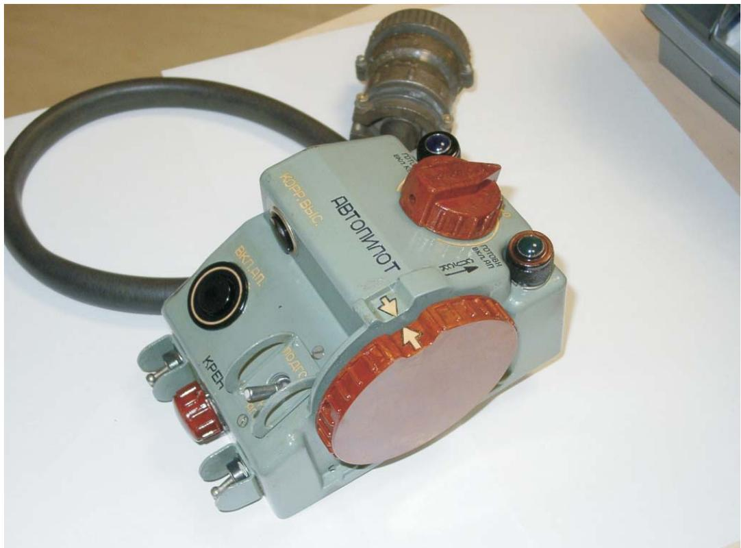
Abbildung 3.2.5.1.2-1: Autopilot des Verkehrsflugzeuges IL-14
