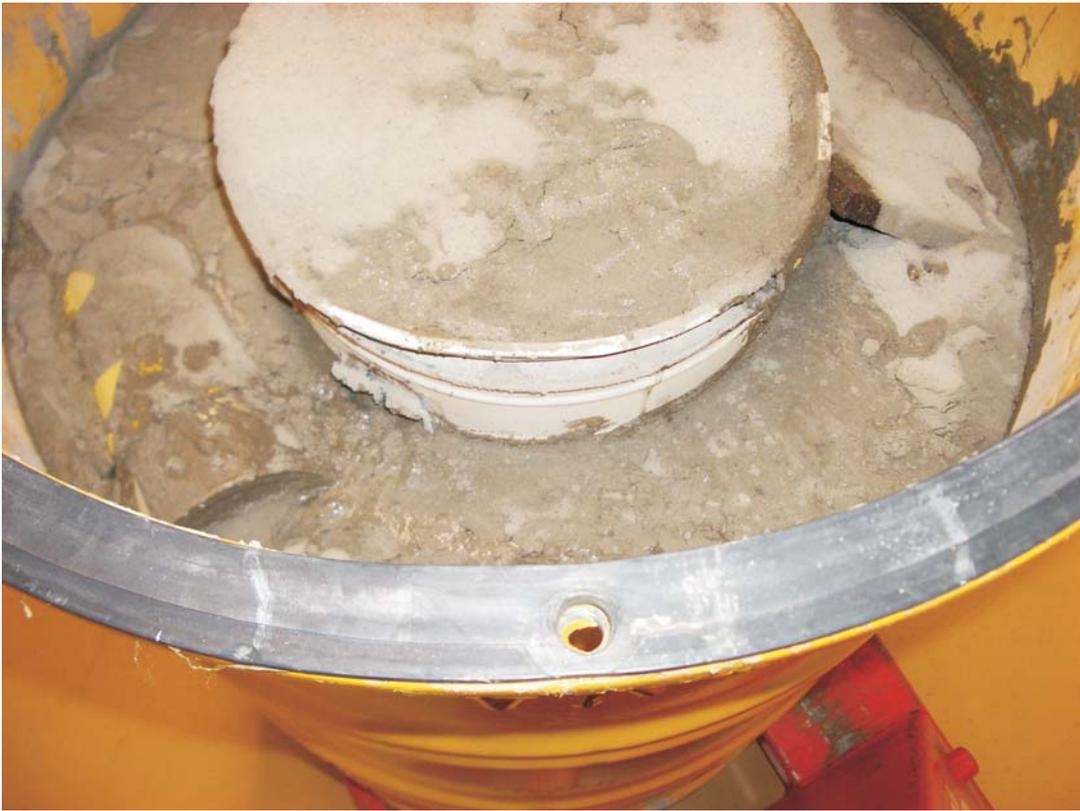
Abbildung 3.2.5.1.2-2: Quellzementierung im 200-Liter Fass
