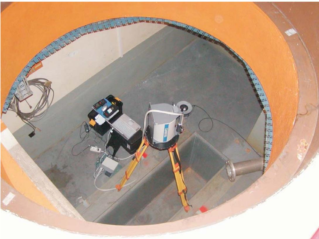
Abbildung 3.5.3-2: Einsatz der In-situ-Gammaspektrometrie im ZLFR
