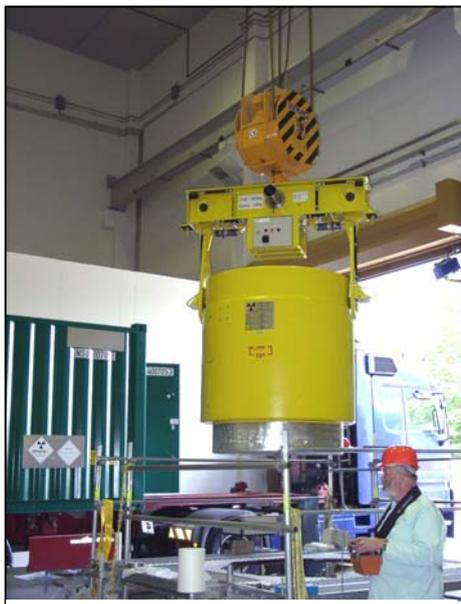
Abb. 3.3.7-1: Beladung eines Transportcontainers mit einem CASTOR MTR 2-Behälter zur Abgabe in das TBL Ahaus
