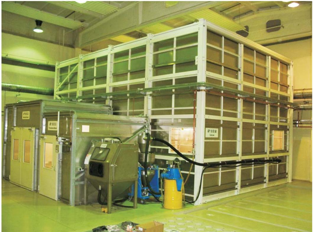
Abbildung 3.2.5.1.1-1: Caisson des Gebäudes 86 mit Personen- und Materialschleuse
