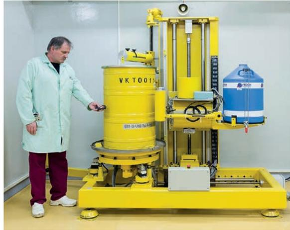
Deklaration des Rückbauabfalls am Fassmessplatz des VKTA
