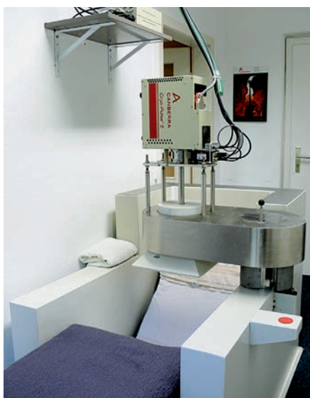
Im Ganzkörperzähler liegen die Probanden in einer sogenannten Kippstuhlgeometrie unter dem Detektor und werden in ca. 30 min gemessen
