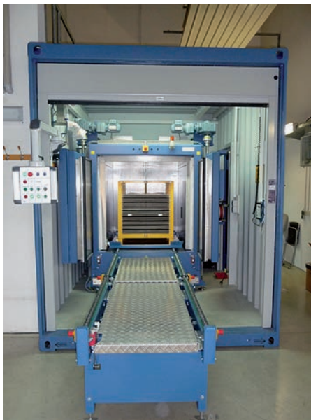
Geöffnete Messkammer mit Kalibriergebinde und Kettenförderer
