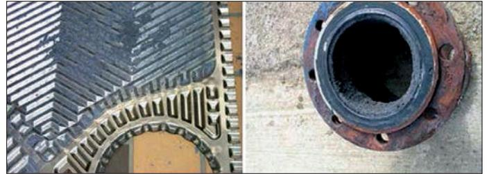
Typische Scales aus einer Geothermieanlage, rechts aus einem Flansch, links Ti-Plattenwärmetauscher
