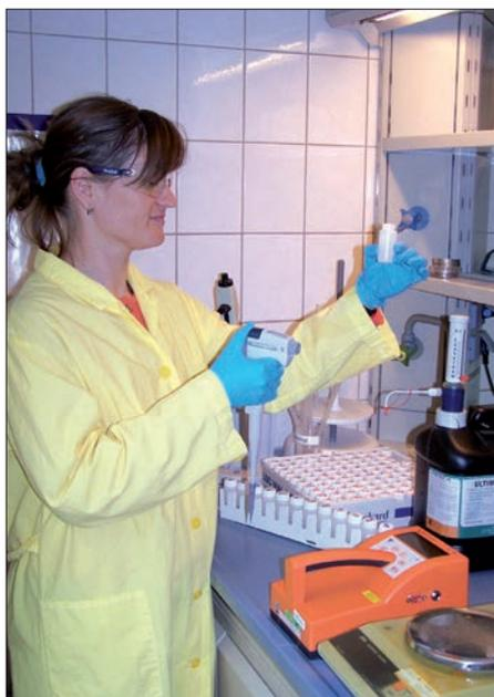
Probenvorbereitung für Messungen im LSC (Liquid Szintillation Counter)
