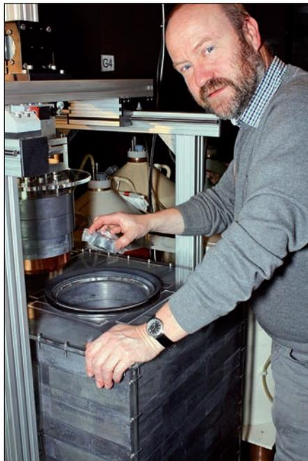
Probenwechsel am Ultra-Low-Background-Detektor
