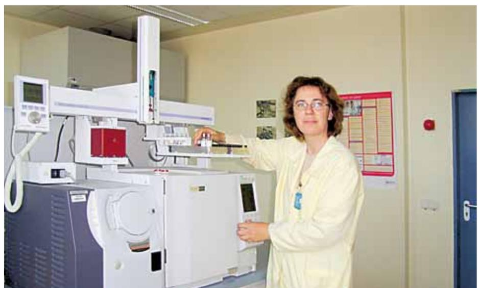
Mitarbeiterin am GC-MS-Gerät während der Analyse von PCB-Proben aus dem Rückbau
