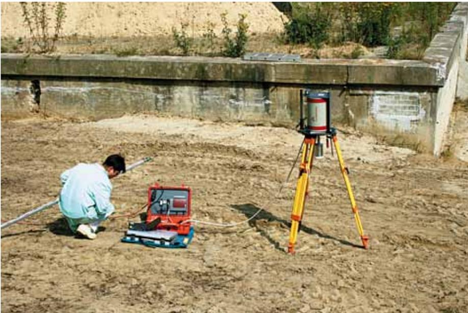
Messungen mittels In-situ-Gammaspektrometrie im Umfeld des Gebäudes 99
