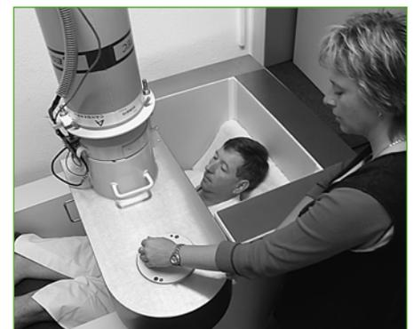
Für eine Routinemessung wird der Detektor des Ganzkörperzählers über die auszumessende Person positioniert
