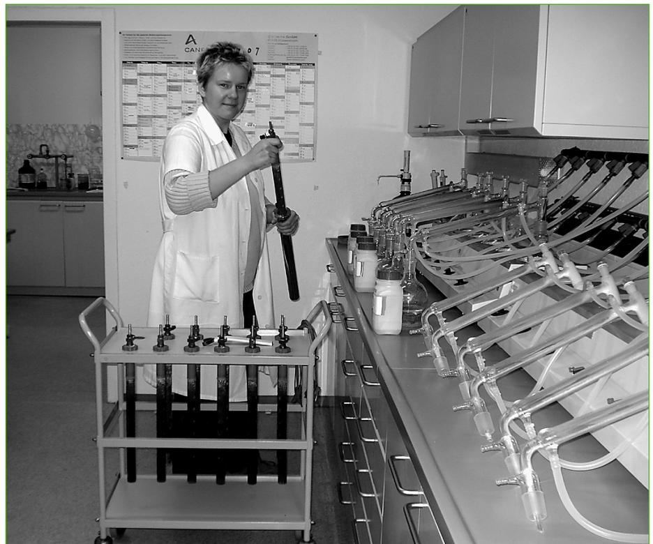
Abb 1. Karin Berger bei Arbeiten zur elektrolytischen Anreicherung von Tritium
