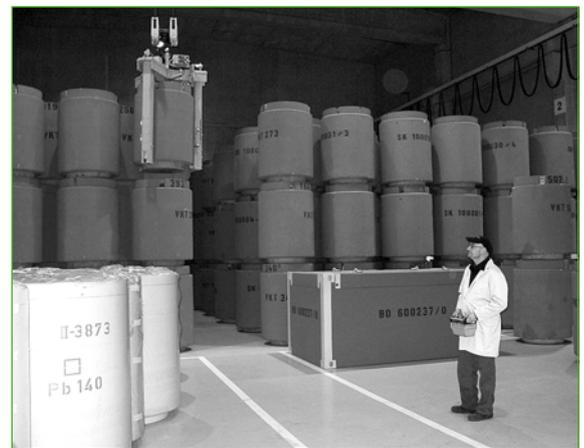
Radioaktive Abfälle in Abschirmbehältern im Zwischenlager Rossendorf
