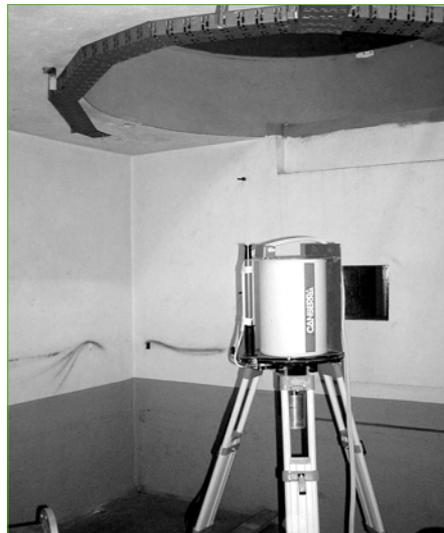
Freimessen der Reaktorbehältergrube mittels „In-situ Gammaskopmetrie“
