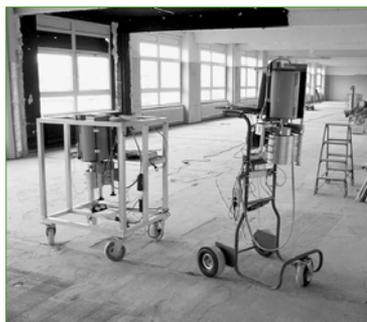
In-situ Gammaskopmetrie des VKTA bei Messungen
