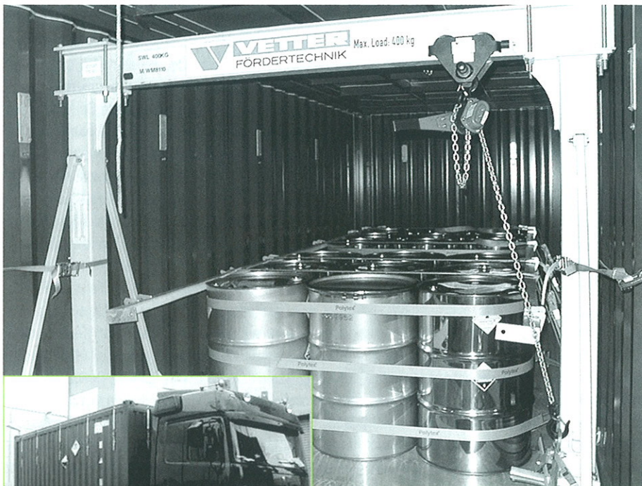
Großes Foto: Blick in den Transportcontainer mit 200 l-Edelstahlfässern, gefüllt mit abgereicherter Uranylнитratlösung
