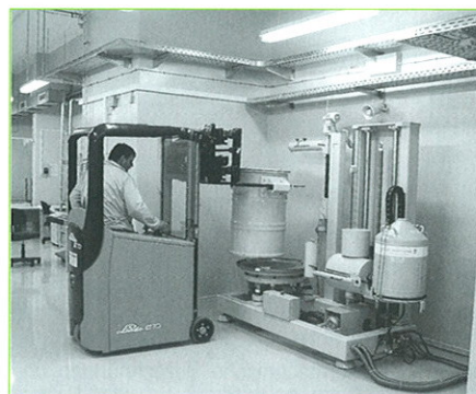
Ermittlung des Aktivitätsinventars mittels Gamma-Scanning
