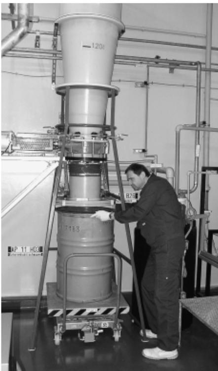
Andocken eines Abfallfasses an die Harztrocknungsanlage
