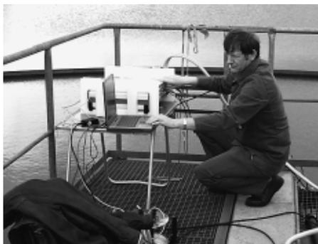
Elektrochemische Messungen an Rohrleitungen
