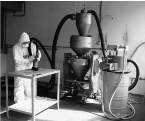
Druckstrahlmaschine beim praktischen Einsatz
