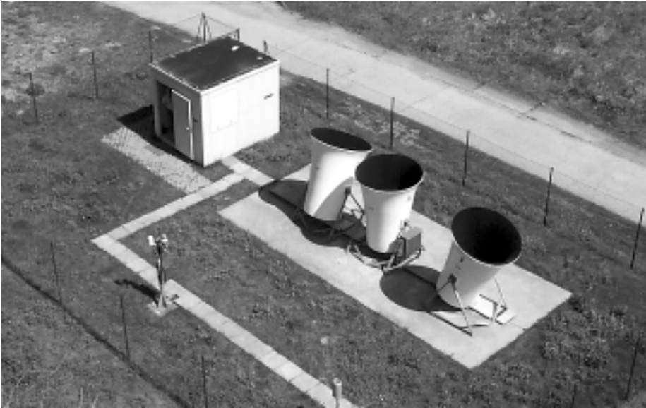
Blick auf das Meteorologische Messfeld mit den drei SODAR-Antennen
