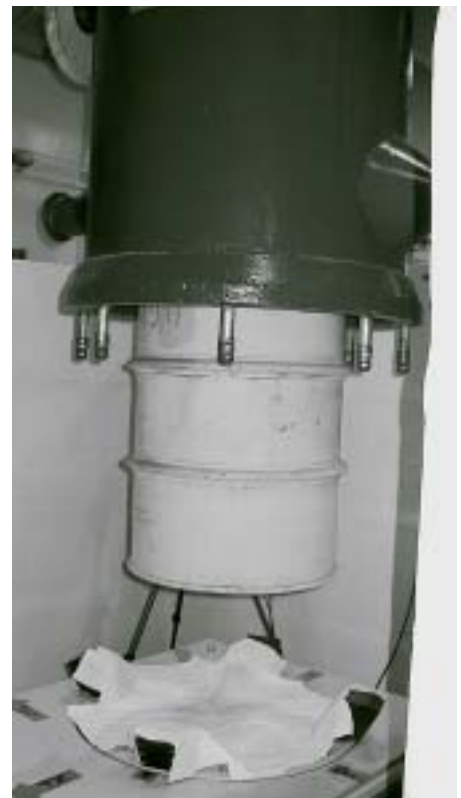
Fernbedientes Absetzen eines mittelradioaktiven Fasses auf den Messplatz
