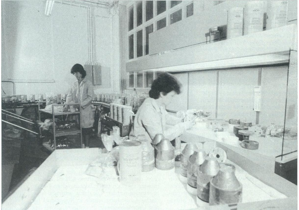
Anlage zur Produktion von Molybdän-99/Technetium-99m-Generatoren.
