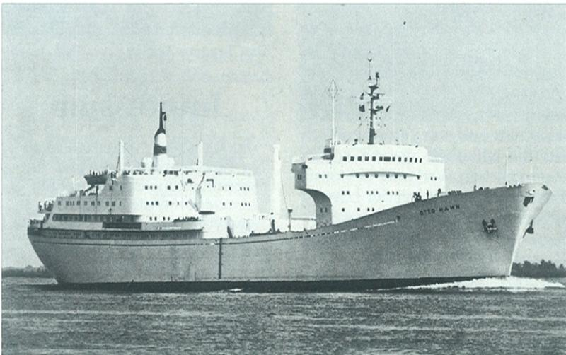
Das 1964 für Forschungszwecke entwickelte nuklearbetriebene Frachtschiff »Otto Hahn« (Länge: 172 Meter, Breite: 23 Meter, Tiefgang: 9,20 Meter) schaffte 17 Knoten. Es legte von 1968 bis 1979 rund 205.000 Seemeilen zurück. Foto: Noell
