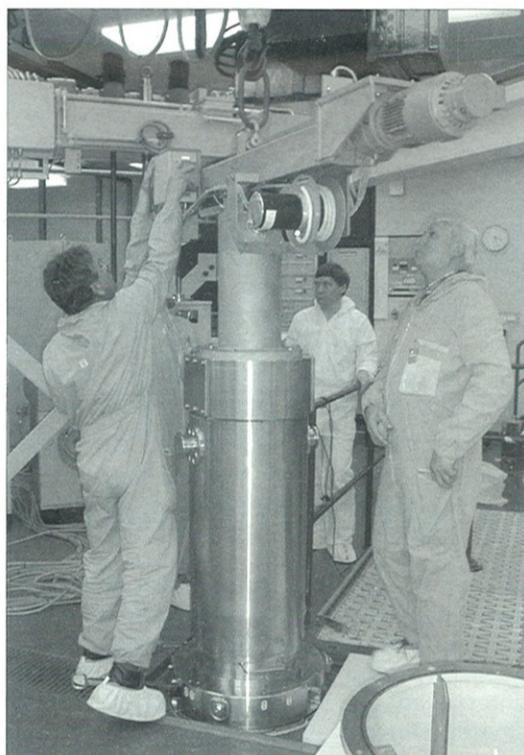
Transferbehälter mit aufgesetzter Ladeeinheit-Umladevorrichtung auf der mobilen Umladeschleuse bei der Umladung einer Ladeeinheit in den Tragkorb des GNS 16.
