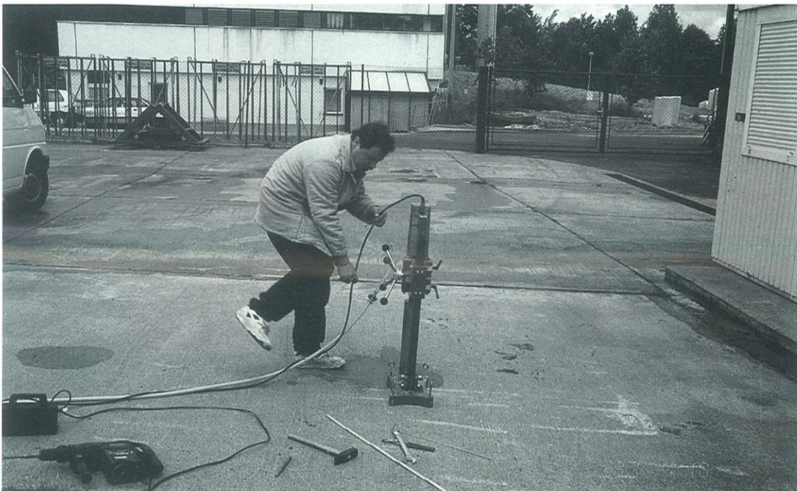
Beprobung einer betonierten Lagerfläche mit Kernbohrgerät.
