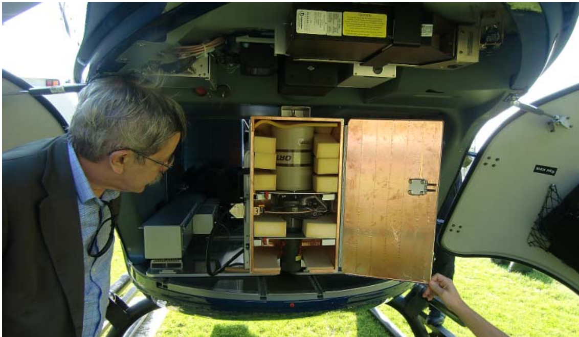
Abb. 3.17: Blick in das mit Messtechnik umgerüstete Heck des BPOL-Hubschraubers, in der Bildmitte der Halbleiterdetektor, links unten einer der NaI-Detektoren
