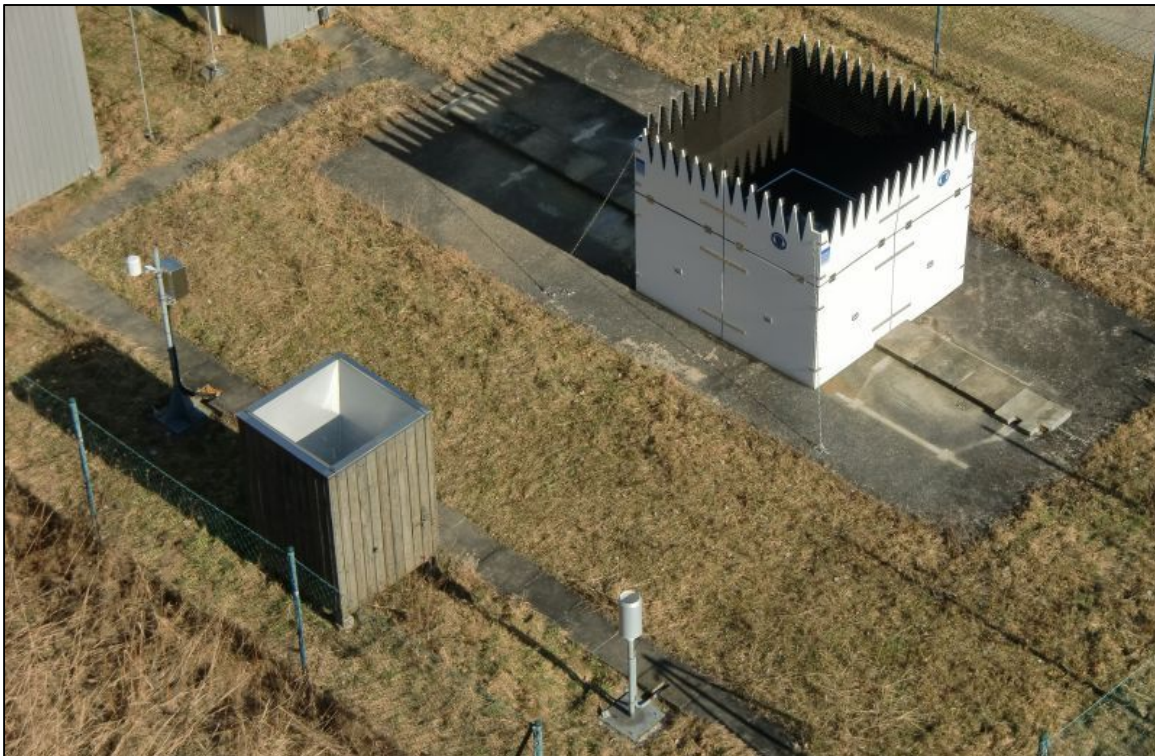
Abb. 3.6: Meteorologisches Messfeld mit neuem SODAR, T-F-P-Messsensorik und Niederschlags-sammler
