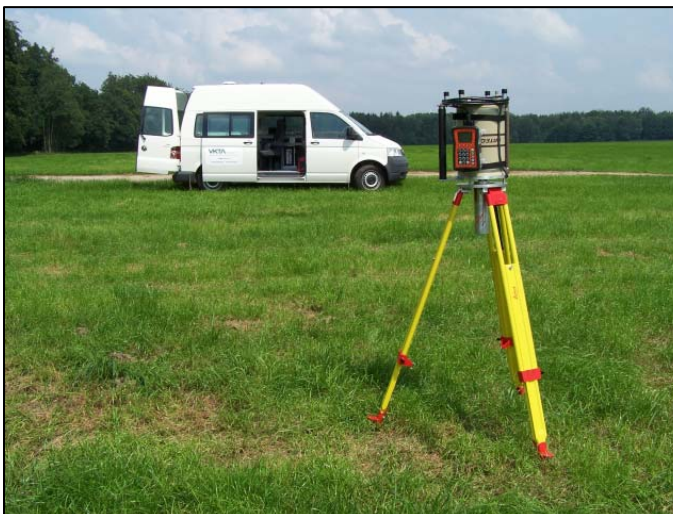
Abbildung 4.15: Neues Messfahrzeug VW T5 mit in situ- \gamma -Spektrometer am Messpunkt Wilschdorf
