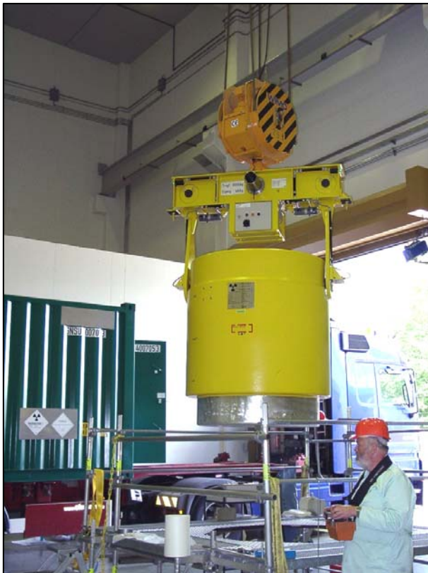
Abbildung 9.1: Beladung eines Transportcontai- ners mit einem CASTOR MTR 2- Behälter zur Abgabe in das TBL Ahaus
