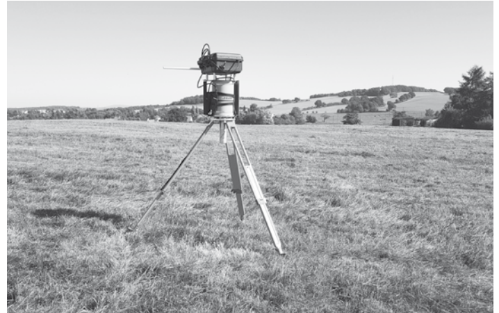
In-situ-Gammaspektrometrie im Hochland, im Hintergrund Dresdens höchster Berg
