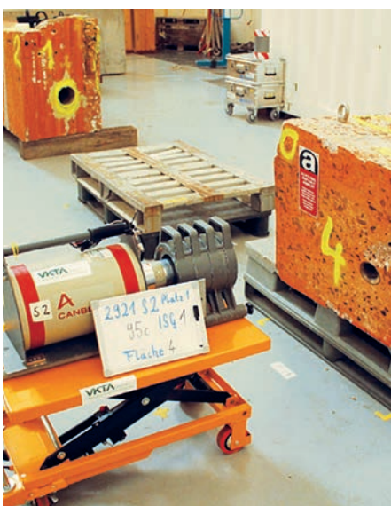
Messung eines Betonblocks
