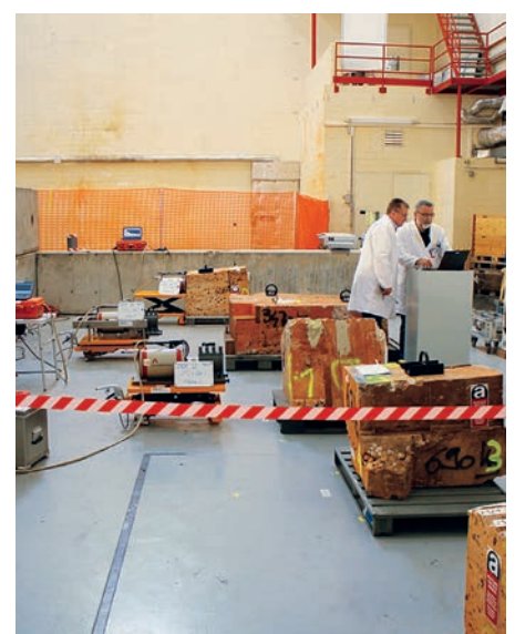
Messung der Betonblöcke mittels In-situ-Gammaspektrometrie
